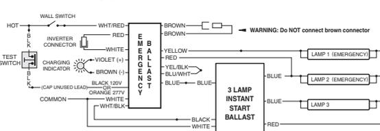
FIG 129 FOUR (4) LAMP INSTANT START BALLAST
