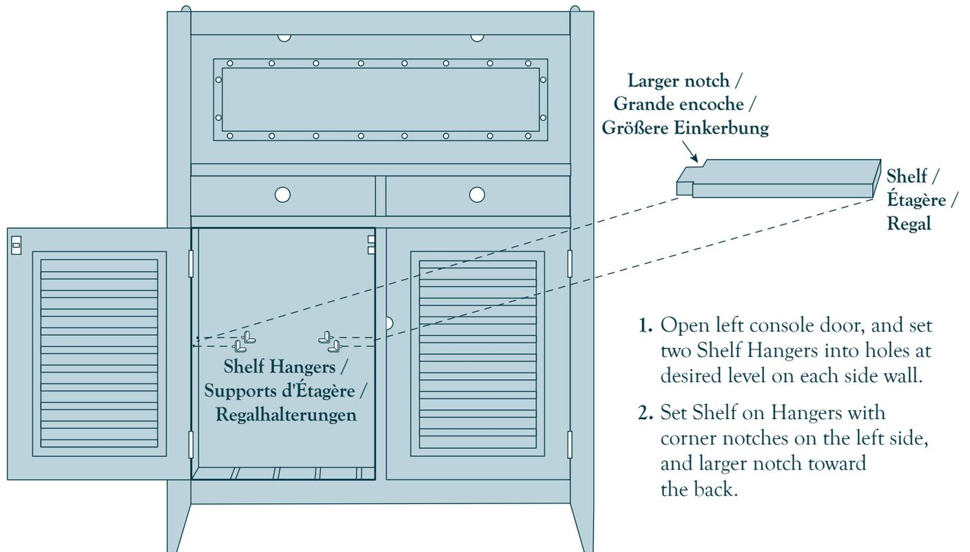
1. Ouvrez la porte gauche de la console et placez les deux supports d'étagère dans les trous à la hauteur désirée de chaque côté.
